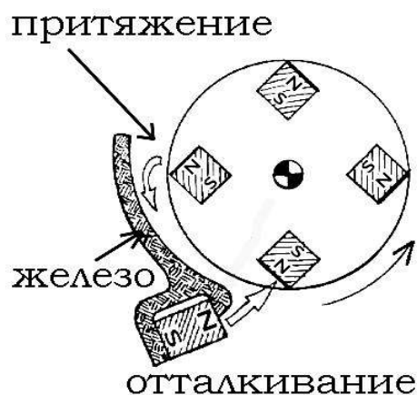
Obr. 165. Magnetický motor s stínění část cyklu.
