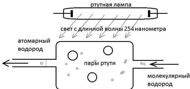
Obr. 235. Systém Bonhoeffer pro získání atomárního vodíku.
