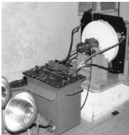
Obr. 189. unipolární generátor Tewari.
