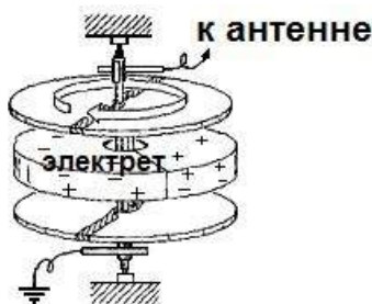
Obr. 77. Elektrostatické motoru Efimenko elektretový rotoru.
