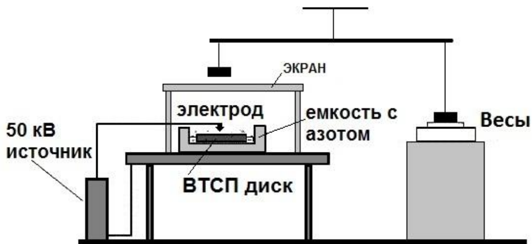
Fig.106. Schéma Frolova experimentu o vlivu elektrického výboje
