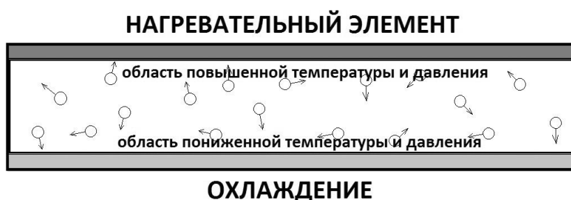
Obr. 100. Schéma propulsor použití gradientu teploty vnitřního prostředí.
